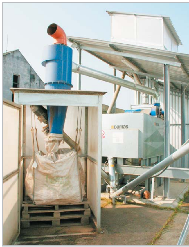
Vpředu prachová komora, vzadu pak síťová čistíčka DAMAS o výkonu 30 tun za hodinu
