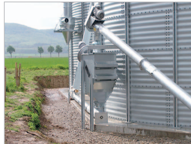
Aspirační čističky Neupro s výkonem až 120 t/h jsou velice jednoduché, ale velmi účinné při odstranění nežádoucích příměsí a lehkých nečistot Foto archiv
