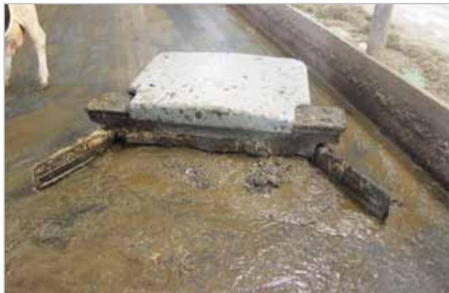
Autonomní robotické zařízení Mirobot 3.0 určené k odkluzu výkalů pracuje samostatně, je bezpečné, tiché a velice přátelské ke zvířatům Foto Vladislav Fuka
