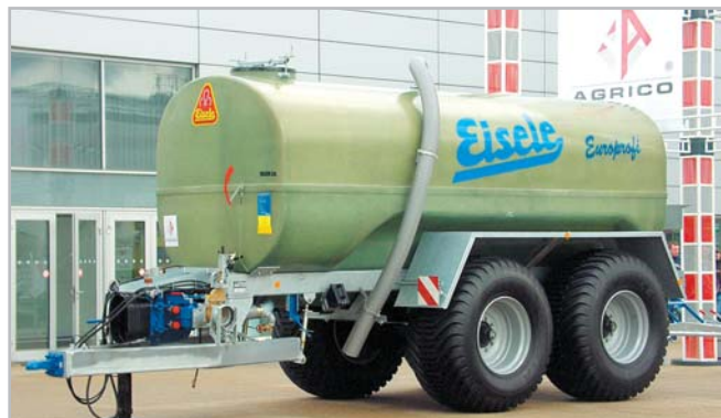
Tandemový návěs Eisele o objemu 18 m 3 je určen k aplikaci kejdy i k přepravě na pozemních komunikacích Foto Vladislav Fuka
