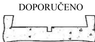
Stěny přikloněny o 1 až 2°
