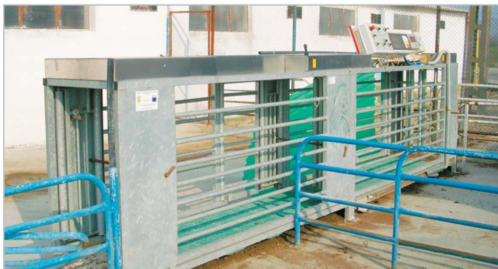
Automatická kontrolní váha slouží k průběžné selekci zvířat vykrmovaných ve velkých skupinách systémem ad libitum
