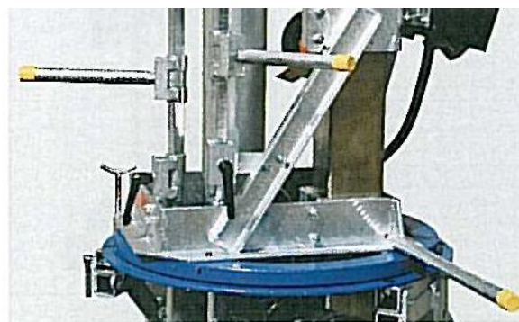
otočný věnec 360° s ruční manipulační pákou
