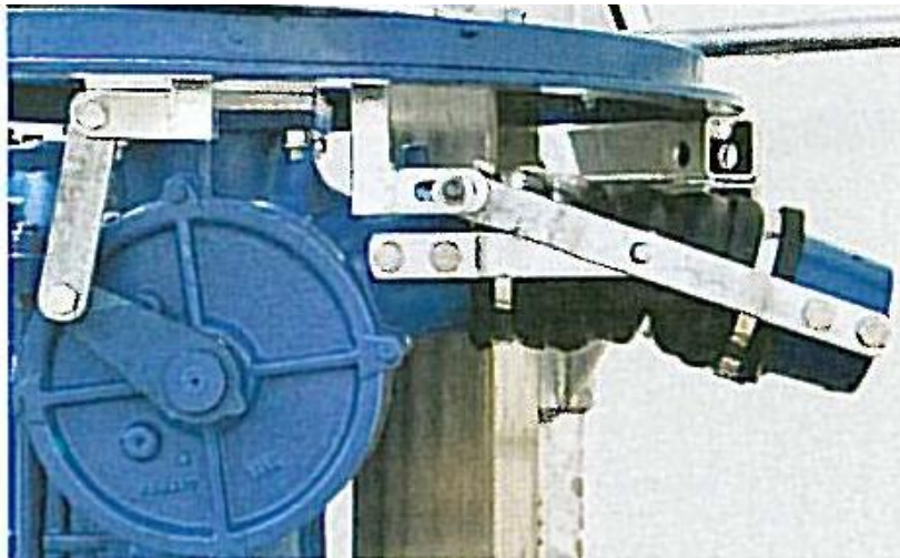
míchací tryska se stabilizací paprsku kapaliny, přestavitelná 45° nahoru a dolů
