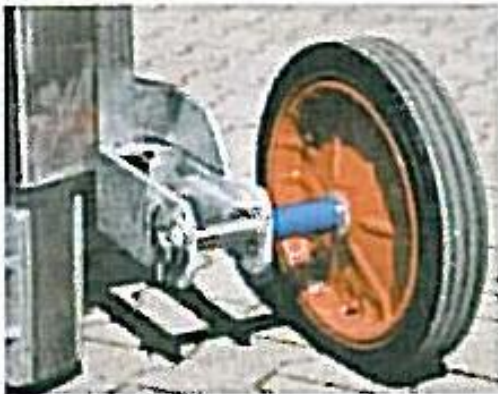
přestavění kola pro širší rozchod s zajištěním (maximálně 1,1 m)
