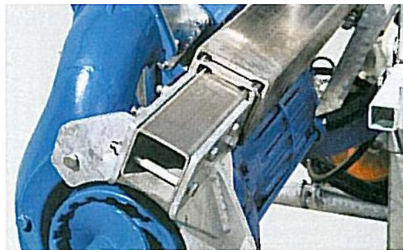
ocelový teleskop (obr.: tři teleskopy do hloubky 4,3 m)
