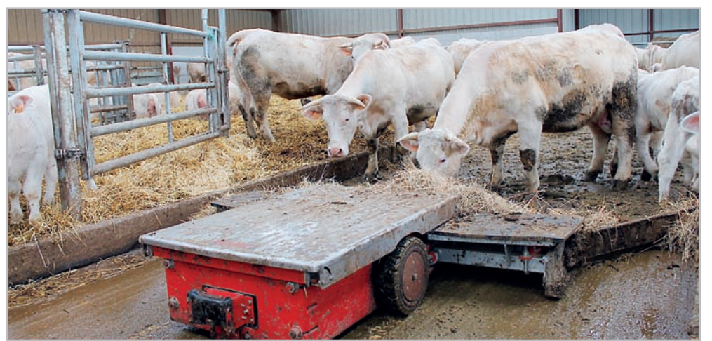
Robotické zařízení pro odklíz výkalů ze stáji pro skot Mirobot 3.0 je schopno odklízet jak tekuté výkaly z bezstelivých stáji, tak i chlěvskou mrvu s vysokým obsahem slámy
