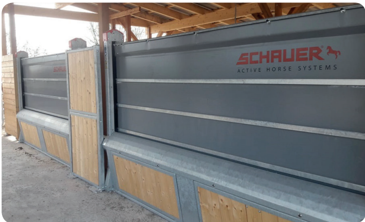
Časově ovládaná krmná stěna v otevřeném a zavřeném stavu. Otevírání a zavírání je zajištěno vertikálním pohybem stěny. Díky tomu nemůže dojít k viznutí hlavy koně v krmném místě
