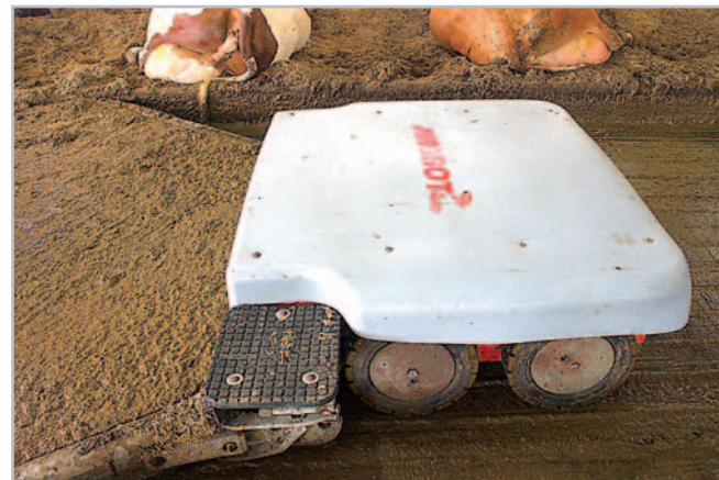
Robotické zařízení se pohybuje rychlostí 4 až 6 m/min a utlačí až 1100 kg výkalů
