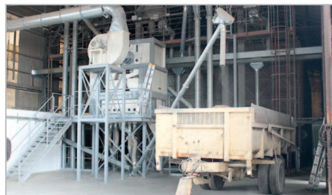
Etážová sesypná čistička Petkus U 12 předčistí za hodinu až 60 tun obilovin Foto Vladislav Fuka
