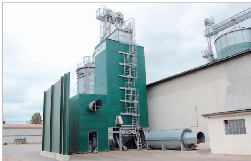
Sušička Neuero NDT 7 o kapacitě 30 tun s vyrovnávacím zásobníkem o objemu 100 tun Foto Vladislav Fuka
